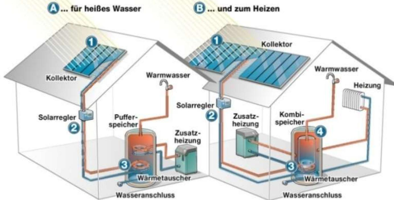
1 Sonnenstrahlen erwärmen den Kollektor und die darin enthaltene Wärmeträgerflüssigkeit.
